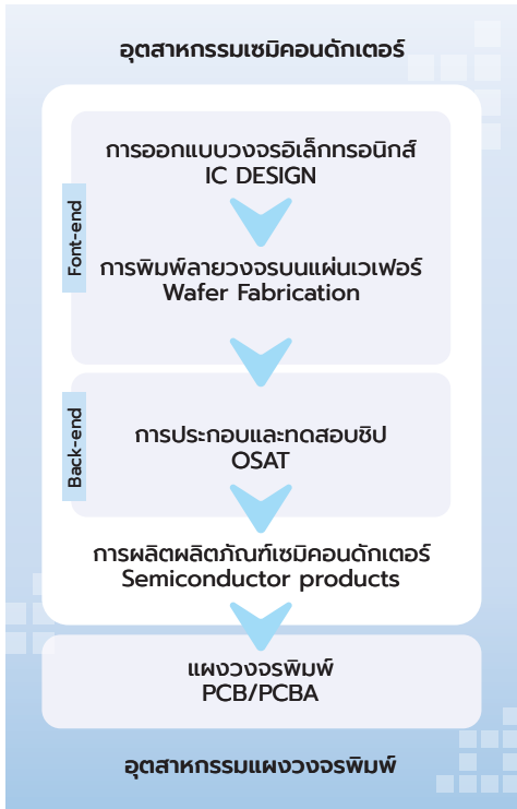
ภาพที่ 1 แสดงห่วงโซ่คุณค่าการผลิตอุตสาหกรรมเซมิคอนดักเตอร์และอุตสาหกรรมแผงวงจรพิมพ์
