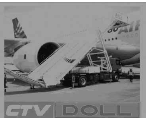
E8000 Rescue and Evacuation Stair เป็นลิฟต์ที่มีบันไดสำหรับใช้งานในสนามบินและเครื่องบิน A380 เป็นรถลำเลียงบันไดขึ้นลงสำหรับผู้โดยสารจากเครื่องบิน
